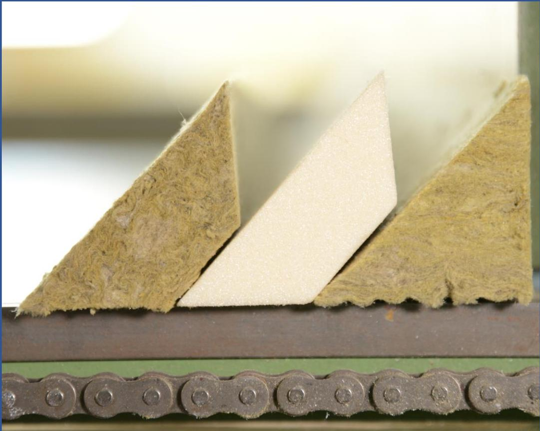
Keile gibt es – je nach Anforderung – in unterschiedlichen Materialien und Größen. Sie werden unter anderem im Dachrandbereich eingesetzt, um das Einknicken der Dachbahn zu vermeiden. Als Gegengefällekeil eignen sie sich hervorragend, um ein Kontergefälle zu erzeugen.
