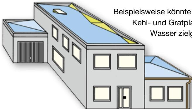
Beispielsweise könnte eine Punktentwässerung mit Kehl- und Gratplatten oder Dachreitern das Wasser zielgenau in Rinne und Gully leiten.
